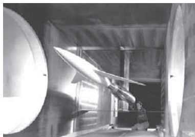
Obrázek 7: Obří nadzvukový tunel v Ames Research Center, NASA, USA. Velikost měřicího prostoru 2,7 \times 2,1 m.
