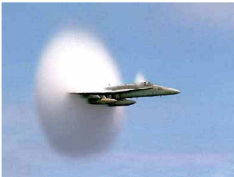
Obrázek 5: Letoun FA-18 Hornet při překročení rychlosti zvuku. Skokové změny stavových veličin na čele rázové vlny způsobují kondenzaci ve vlhkém vzduchu.
