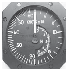
Obrázek 6: Machmetr LUN 1170, stupnice v uzlech \times 10 a M .
